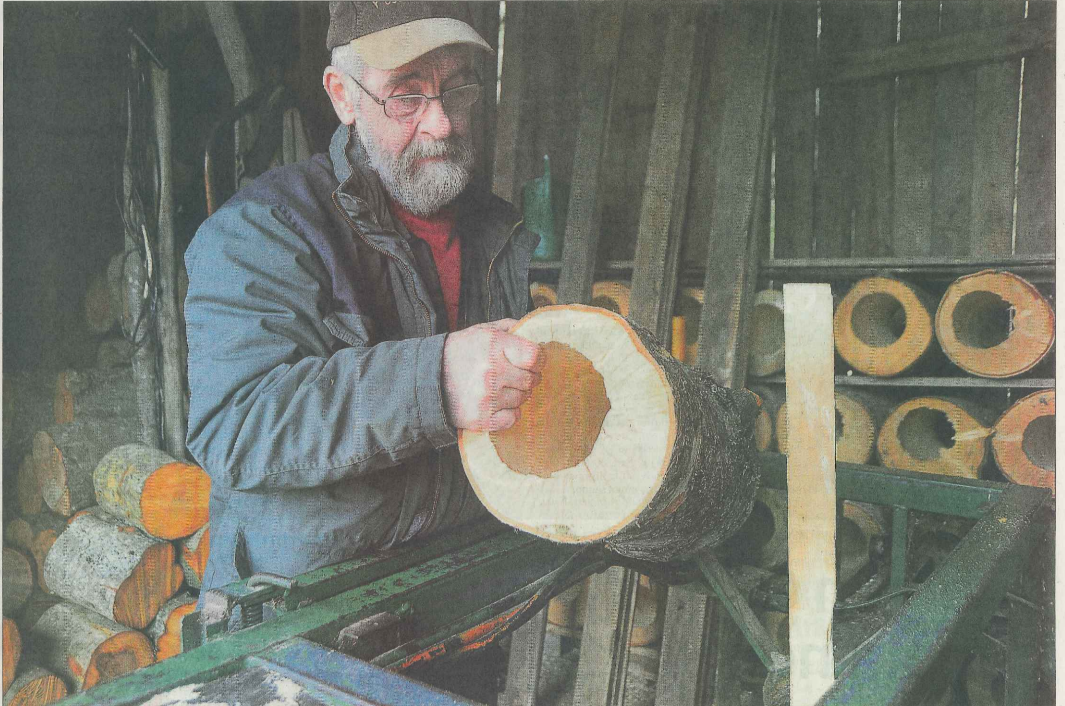
Seppo Liikala työstää pönttöihin reiät kyläsepan valmistamalla traktorikäyttöisellä sorvilla. Koivupönttö on kaunis mutta haapapönttö on kestävin. Se tarjoaa linnuille pesäpaikan kymmeneksi vuodeksi.
